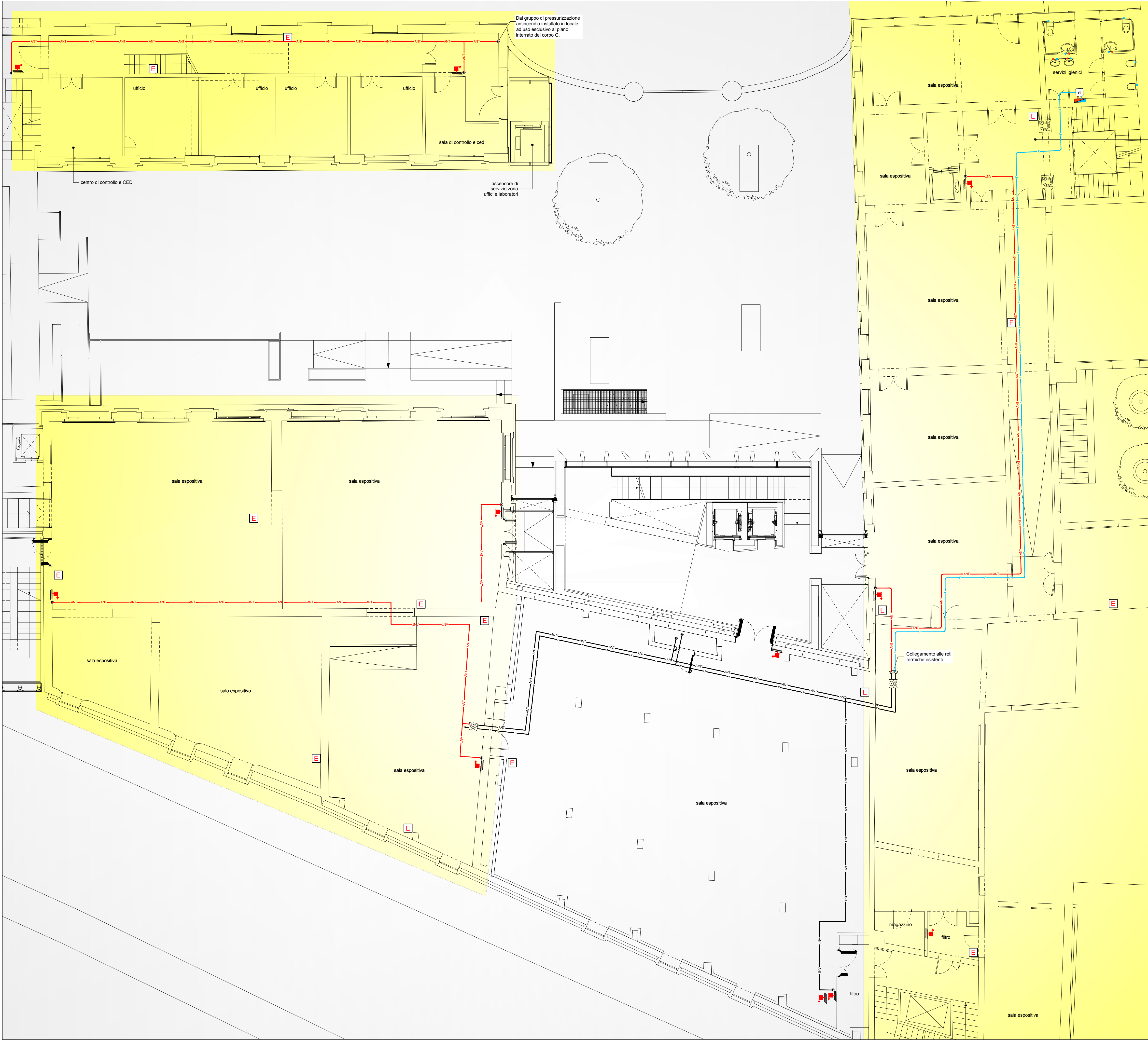
PIANTA PIANO PRIMO - DISTRIBUZIONE IMPIANTO IDRICO E ANTINCENDIO - SCALA 1:100 -
