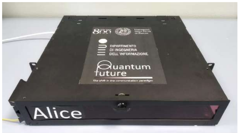
Il trasmettitore QKD - L'intero sistema di trasmissione è chiuso in un contenitore rack standard da 19 pollici, come quelli che si trovano comunemente nelle server room. (Immagine fornita da: Luca Calderaro, Università degli Studi di Padova)
