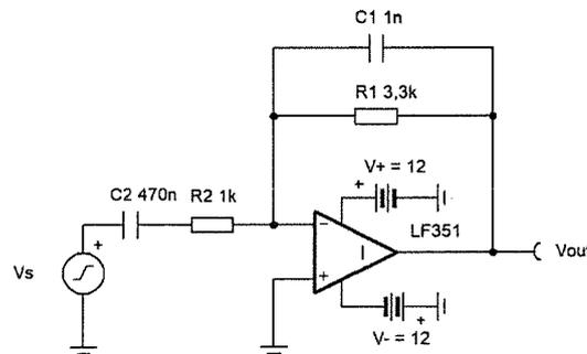
$V_s$  è la sorgente del segnale, ottenuto dal generatore di funzioni disponibile sul banco;  $V_+$  e  $V_- = 12V$  sono le tensioni di alimentazione del circuito, ottenute dal generatore di tensione a due canali disponibile sul banco.
