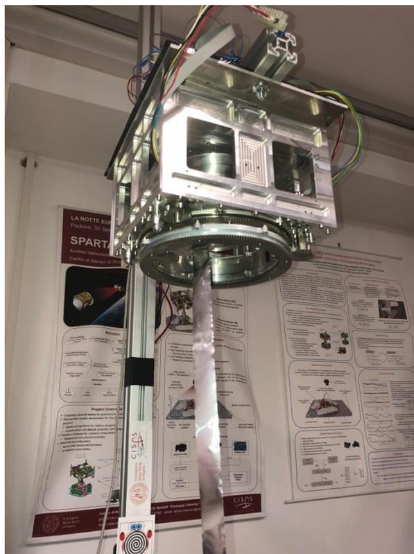
Il deployer di E.T.PACK nel laboratorio SPARTANS del Dipartimento di Ingegneria Industriale – UniPD soggetto a test funzionali
