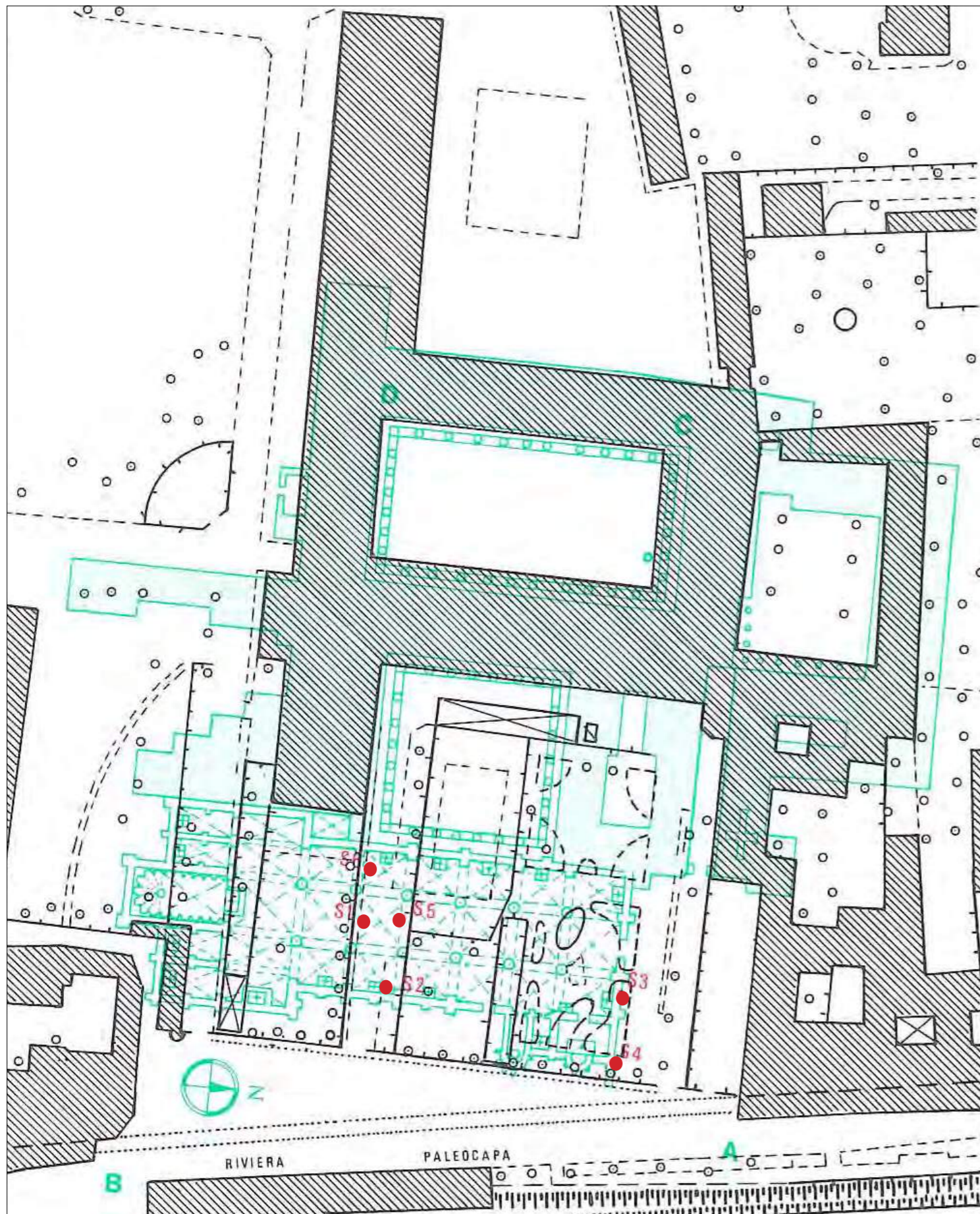
Caserma Piave (già convento di Sant'Agostino) Indicazione dei punti ove sono stati eseguiti i sondaggi geognostici
